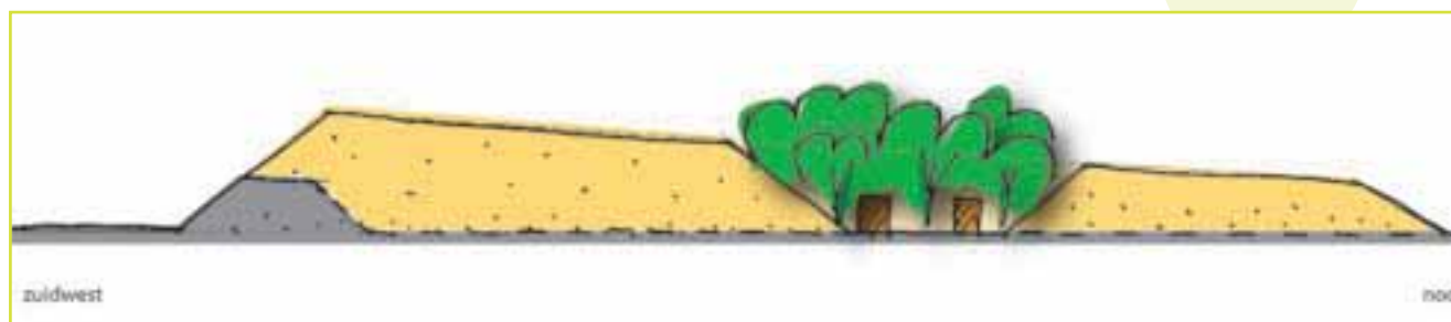
Dwarsdoorsnede terp bij trafostation.
